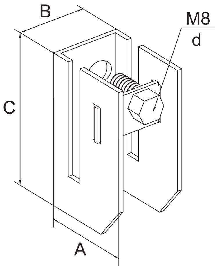
Предназначен для крепления полосы толщиной до 8 мм к стене здания.
